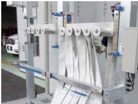
▲水に濡れたホースを乾かすためにホースハンガーに掛け、電動もしくは手動にて上部に持ち上げます。
