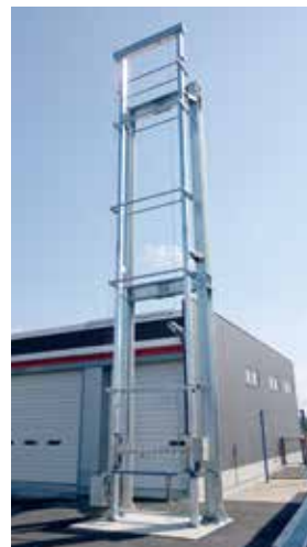
▲上部に持ち上げた際に下にある連結部は、風により煽られないようにベルトで固定します。
