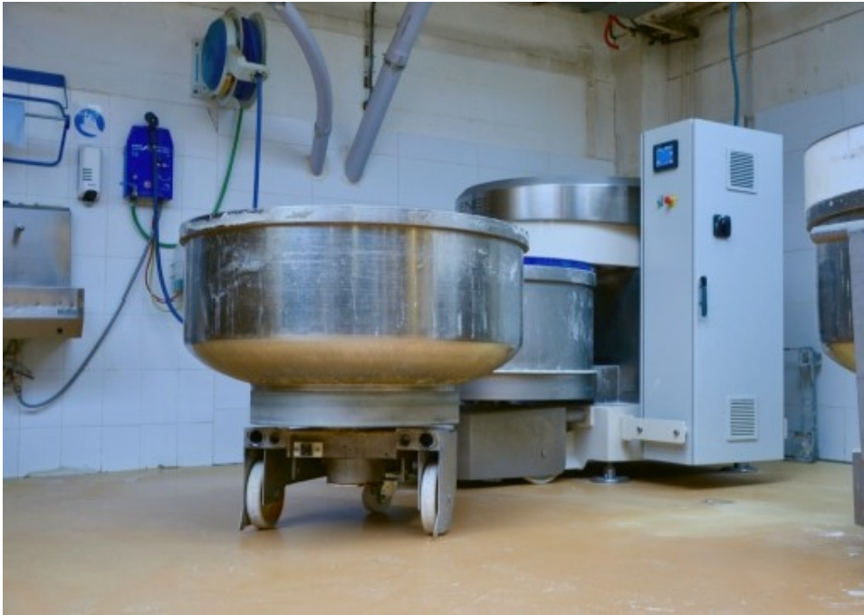
Le sol devait résister aux lourdes charges mécaniques. Il y a des cuves d'une tonne qui passent dessus, posées sur trois roulettes en nylon
